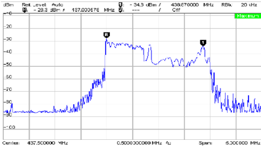
Rys. 9. Spektrogram widma odbieranego w Redzie. Zysk układu antenowego około 7 dBi
